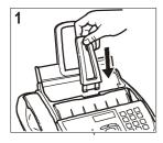
Insérez le support des originaux dans la fente correspondante, et poussez-le jusqu'à ce qu'il s'enclenche en position.
