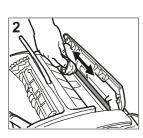
Nettoyez le miroir du lecteur optique avec un chiffon imbibé d'un produit de nettoyage pour les vitres, puis essuyez-le soigneusement.
