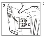
Retirez éventuellement le couvercle protégeant la prise de connexion à la ligne téléphonique "EXT" sur le télécopieur, et insérez ensuite le connecteur du répondeur automatique externe ou du téléphone externe dans cette prise (C).
