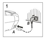
Raccordez la fiche (A) située à une extrémité du câble d'alimentation électrique au connecteur placé sur le côté arrière de l'appareil.
