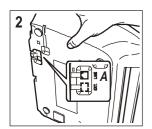
Insérez le connecteur "miniature" (transparent) du câble de connexion à la ligne téléphonique dans la prise "LINE" située sous le télécopieur (A).
